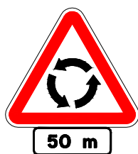
Figura 3.19 – Sinal B7 com painel adicional Modelo 1a (50 m)
